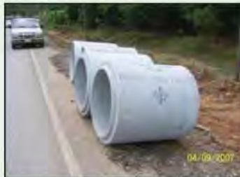
รูปที่ 5-3 ลักษณะท่อที่ดี ผิวเรียบ ไม่มีพรุน ปากไม่บิ่น ไม่มีรอยแตกร้าว
