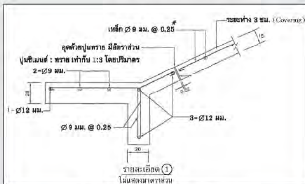
รูปที่ 5-36 ตัวอย่างแสดงการเสริมเหล็กกำแพงปากท่อ
