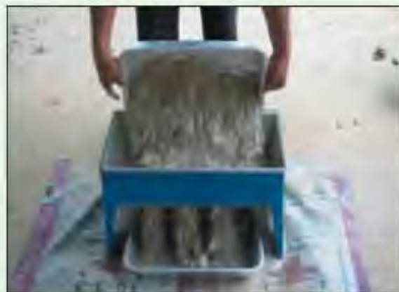
รูปที่ 3 - 6 แสดงวิธีแยกวัสดุโดยใช้เครื่องแบ่งแยกวัสดุ (Sample Splitter)
