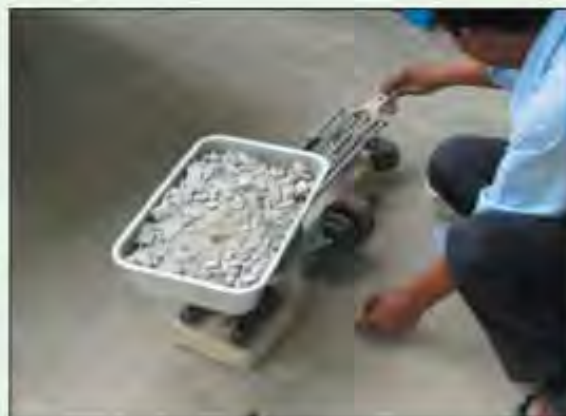
รูปที่ 3 - 6 แสดงวิธีแยกวัสดุโดยใช้เครื่องแบ่งแยกวัสดุ (Sample Splitter)
