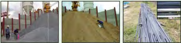
รูปที่ 5-18 การเก็บตัวอย่างวัสดุเพื่อทำการทดสอบ
