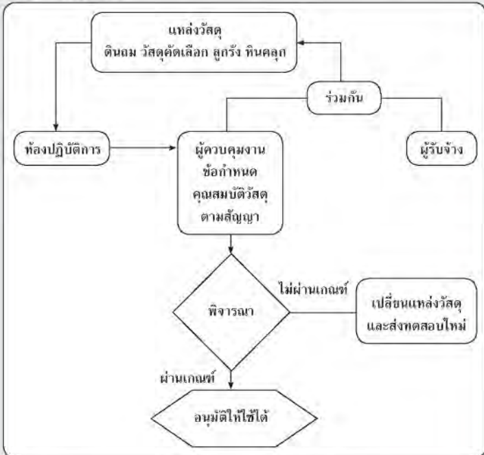
รูปที่ 3-2 ผังกระบวนการงาน General Test
