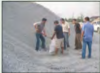
รูปที่ 3-15 การเก็บตัวอย่างวัสดุมวลรวมหยาบ (Coarse Aggregates)
